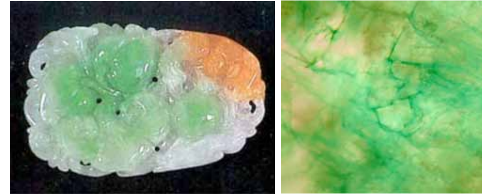
รูปที่ 3 เส้นสีหรือจุดสีเขียวที่เกิดจากการสีย้อมไปสะสมตามรอยแตก
