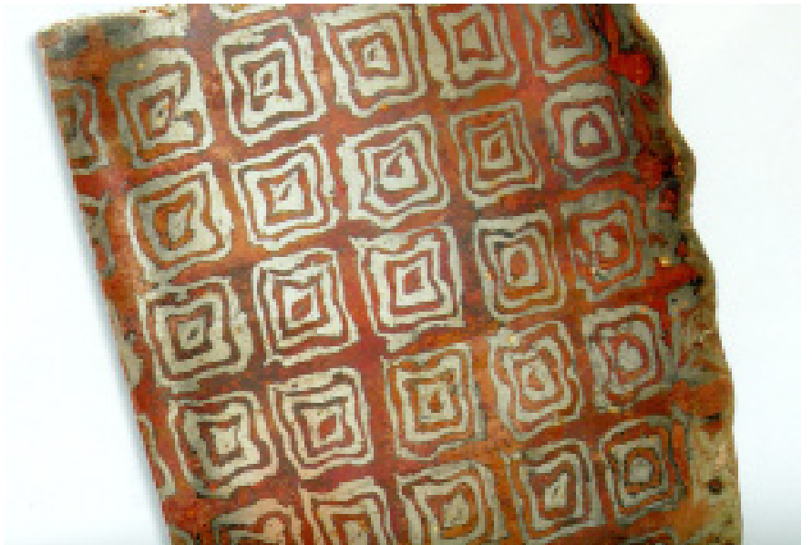
*Mokume Gane เป็นการทาลวดลายที่ประยุกต์มาจากเทคนิคการตีตามซามูไรแบบญี่ปุ่น โดยการนำอัลลอยด์มาประกบและรีดด้วยแรงกดทับขณะร้อนจนเกิดเป็นชั้นของอัลลอยด์ที่ติดกัน เกิดเป็นลวดลายที่มีความแตกต่างกันกับแนวคิดแต่ละบุคคล ภาพจาก Carles Codina
