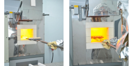
รูปที่ 4 การวิเคราะห์เทคนิค Fire Assay ด้วยเตาหลอมอุณหภูมิสูง
