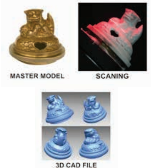
รูปที่ 1 เครื่องสแกน 3 มิติในการผลิตงานต้นแบบ
