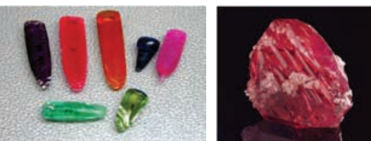
รูปที่ 2 พลอยคอร์รันดัมสังเคราะห์ชนิด flame fusion (ซ้าย) และชนิด Flux grown (ขวา)
