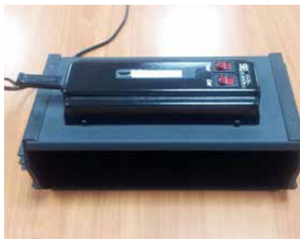
รูปที่ 2 เครื่องตรวจสอบการเรืองแสง Ultraviolet (LW/SW UV Box) ใช้ตรวจการเรืองแสงภายใต้รังสี อัลตราไวโอเล็ต ภาพถ่าย โดย ทศนรา ศรีปุ่นจัน
