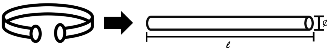
รูปที่ 2 ตัวอย่างการคำนวณพื้นที่ผิวของชิ้นงาน
